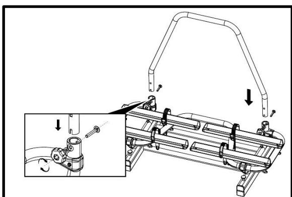
Bevestig deze U-beugel met de bijgeleverde slotbouten (M8x60), sluitringen en kunststof draaiknoppen. Zorg dat de draaiknop aan de voorkant zit.
