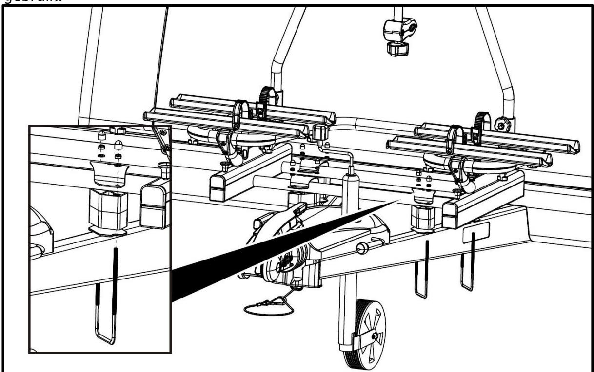
Om er voor te zorgen dat de drager op zijn plaats blijft dient deze geborgd te worden met de vier schroefjes. Hiervoor moeten eerst vier gaatjes (3 mm) geboord worden in het basisdeel en daarna kunnen de beugel en het basisdeel vastgeschroefd worden.
