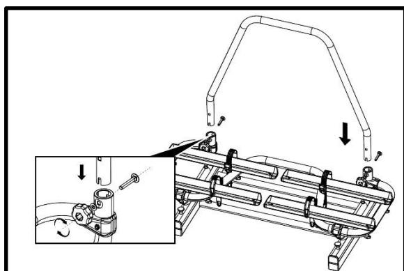
Befestigen Sie den U-Bügel mit den mitgelieferten Schloss - Schrauben (M8x60), Scheiben und den Kunststoff Rändelmuttern. Die Kunststoff Rändelmuttern müssen an der Vorderseite montiert sein.
