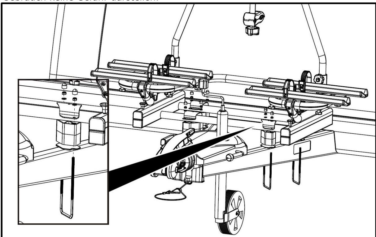
Um dafür zu sorgen, dass der Träger auf seinem Platz bleibt wird dieser fixiert, indem Sie die vier Bohrungen der Gegenbleche in das Basisrohr übertragen. Bohren Sie diese Löcher 3mm groß. Danach wird mit den mitgelieferten Schrauben der Träger fixiert.
