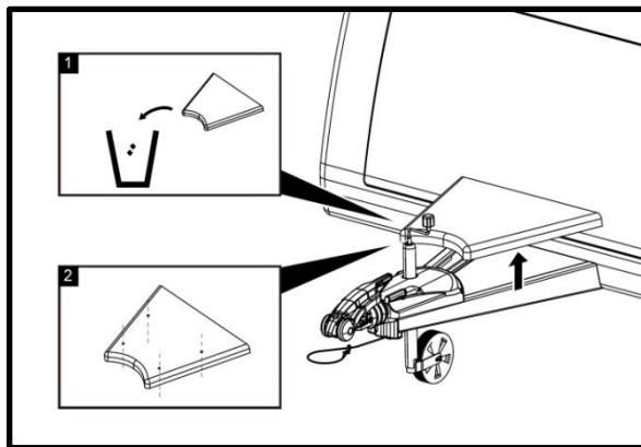
Entfernen Sie die Abdeckhaube der Deichsel (1) oder bohren Sie Löcher in die Abdeckhaube für die Befestigungsschrauben (2).
