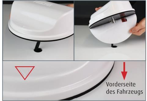
6. Führen Sie die Kabel durch die Öffnung und entfernen Sie die selbstklebende Rückseite des 3M-Montepad. Führen Sie die Kabel durch die Dachöffnung und richten Sie die Antenne so aus, dass der aufgedruckte Pfeil zur Vorderseite des Fahrzeugs zeigt. Die Außenränder der Antenne müssen dabei an der vorher angebrachten Markierung ausgerichtet werden.
