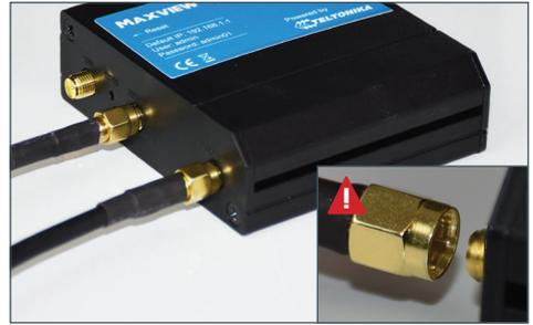
2. Schließen Sie die Koaxialkabel der Antenne an den zwei unteren Anschlüssen an. Sie sind mit dem Wort „mobile“ beschriftet. Die Anordnung der Kabel ist unwichtig.
