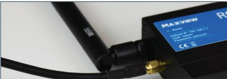
3. Schließen Sie die WLAN-Antenne am oberen Anschluss an. Er ist mit dem Wort „Wi-Fi (WLAN)“ beschriftet. Sie muss vertikal ausgerichtet werden.
