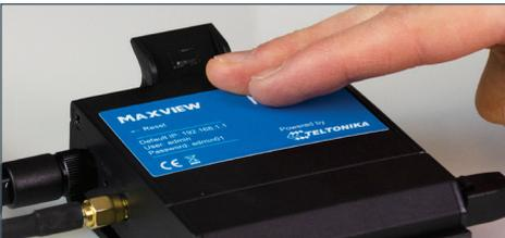
5. Platzieren Sie den Router in der Montagehalterung. Der Router kann jederzeit aus der Halterung genommen werden, wenn Sie die SIM-Karte wechseln müssen.
