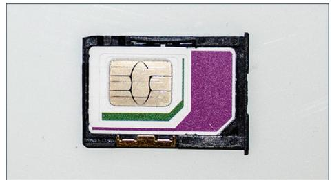
2. Öffnen Sie das SIM-Fach und legen Sie die SIM-Karte in Standard- oder Mini-SIM-Ausführung, flach mit der Chipseite nach oben ein. Vergewissern Sie sich das SIM-Karte richtig im Rahmen des Halters liegt.
