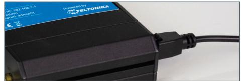
4. Schließen Sie den 12V-Anschluss oder das 230 V Netzteil (optional) an und verbinden Sie das Kabel mit Ihrer Stromquelle.
