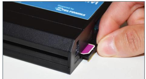
3. Schieben Sie das SIM-Fach mit der Karte wieder in den Router. Die Aufschrift an der Stirnseite des Fachs darf nicht auf den Kopf stehen. Schieben Sie den SIM-Karten-Schlitten in den Router bis er einrastet.
